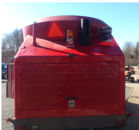
Ofte trænger kølerne til udskiftning. Støv fra kraftfoder og mineraler er en skrap kost for køleribberne, hvis chaufføren forsømmer den daglige renholdelse.
