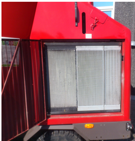
Ofte trænger kølerne til udskiftning. Støv fra kraftfoder og mineraler er en skrap kost for køleribberne, hvis chaufføren forsømmer den daglige renholdelse.
