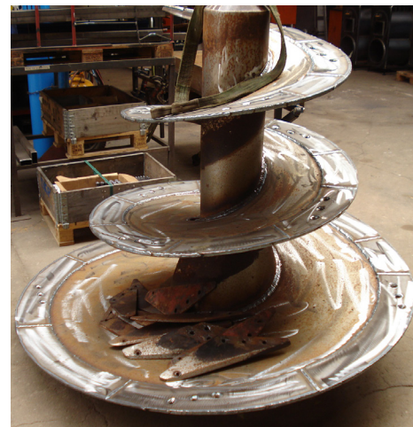
CN Maskinfabrik har stor ekspertise i at renovere konventionelle fuldfoderblandere. Her er det en snegl, der bliver gjort klar til endnu et arbejdsliv.
